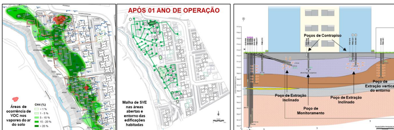
Figura 3. – Malha de SVE nas Áreas Abertas + Resultados / SVE Inclinado sob as edificações com potencial de intrusão
