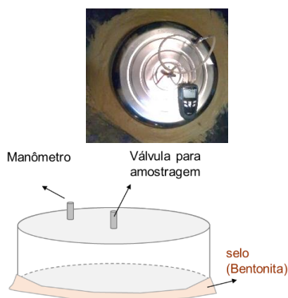
Figura 1: Ensaio de flux chamber com método Estático.
