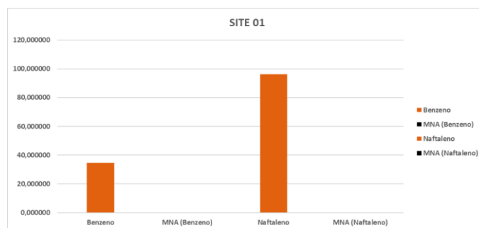
Gráfico 01 – Taxas de degradação médias nas regiões de influência da barreira hidráulica e atenuação natural
